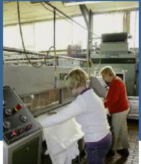
**Geplättet:** Mit Großmaschinen werden in Wäschereien Textilien in Form gebracht.
